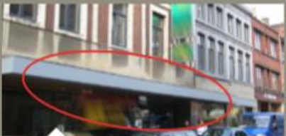
MAUVAIS : Large rez-de-chaussée commercial ne respectant pas le rythme des façades
